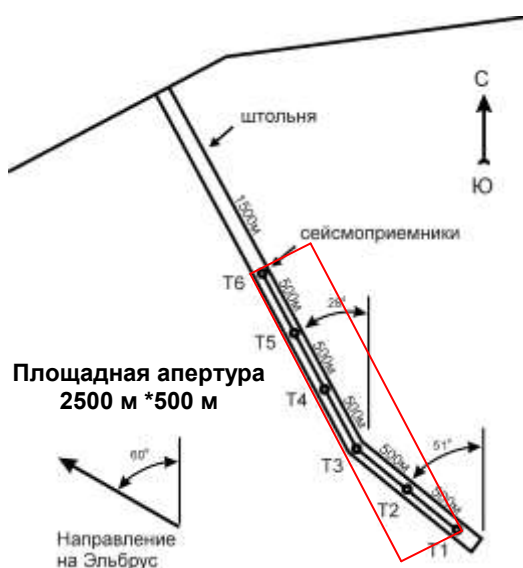
Рисунок 2. Сейсмическая группа в штольне БНО, Т1-Т6 точки установки сейсмоприемников
