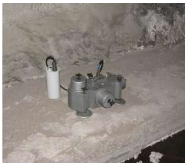
Рисунок 3. Сейсмоприемник СК-1П с регистратором «Байкал» на бетонном основании штольни БНО.
