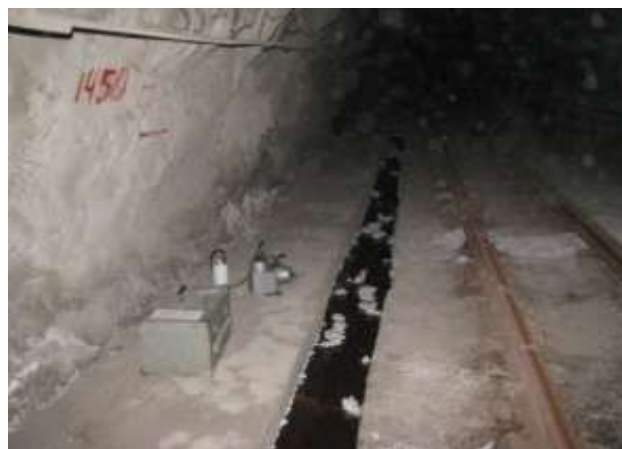
Рис. 5 Расположение сейсмических приемников СК-1П и регистраторов «Байкал» в штольне.
